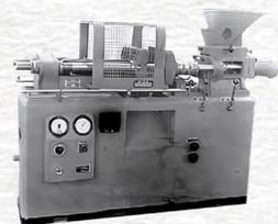
Primera máquina de moldeo por inyección para envases de plástico.
