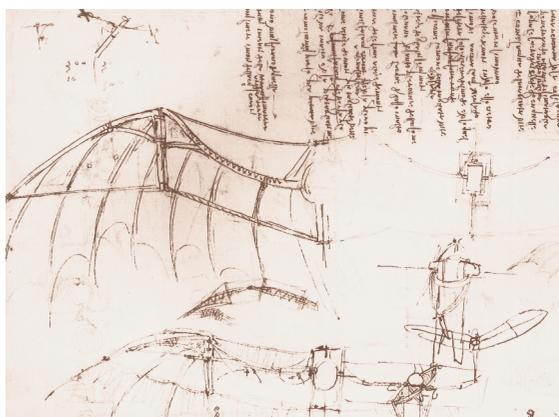
✦ Figura 6. Estudio del vuelo de las aves con intención de aplicar los principios a una máquina.
