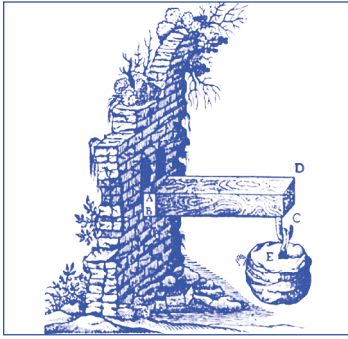
Figura 3. Galileo Galilei. Dibujo que muestra un modelo físico de un voladizo Tomada de: www.goo.gl/wNtOii
